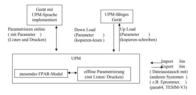
UPM-fähiges Gerät: Gerät kann über eine serielle Schnittstelle, die das UPM-Interface realisiert, mit dem UPM-Computer Datenaustausch vornehmen. z.B.: Gerät TAS 2.1
